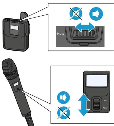
L'émetteur de poche et l'émetteur main SKM AVX-S disposent d'un commutateur **Mute** qui permet de couper le signal audio sans éteindre l'émetteur.
